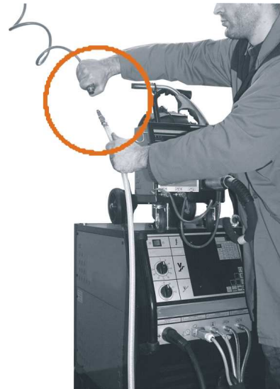
5 – Ligar o tubo de ar comprimido á rede. Pressão min.5 bar, min. fluxo 100 lts/min.
