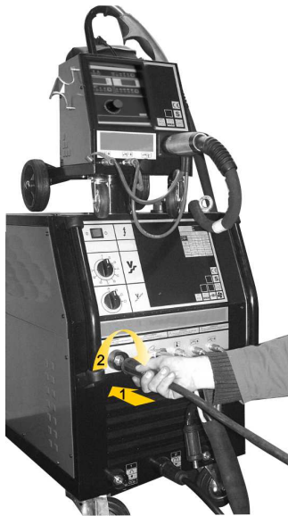
4 – Connecter le câble de puissance du porte-électrode à la prise positive.
