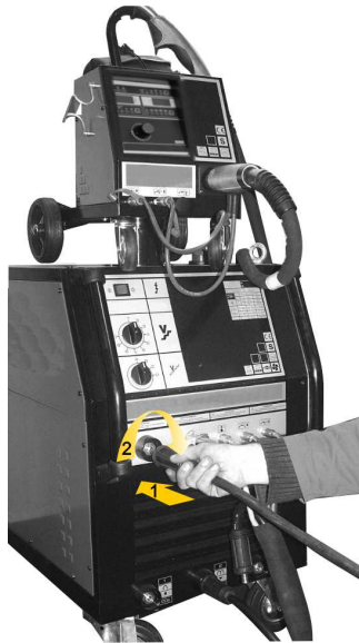
4 – Conectar el cable de potencia del porta-electrodos a la toma positiva.
