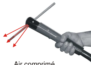
9 - Bien vérifier que le flux d'air comprimé à la sortie du porte-électrode Arcair est dirigé vers la pièce à couper.
