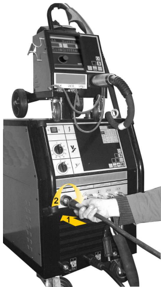
4 – Ligar o cabo de potência do porta-electrodos á tomada positiva.
