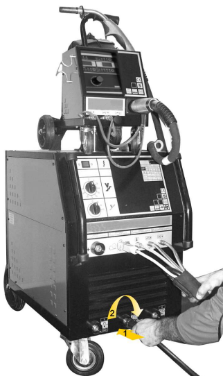
6 – Conectar el cable de masa a la toma central de la máquina y a la pieza a cortar. - Verificar el contacto eléctrico entre la pinza de masa y la pieza de trabajo.
