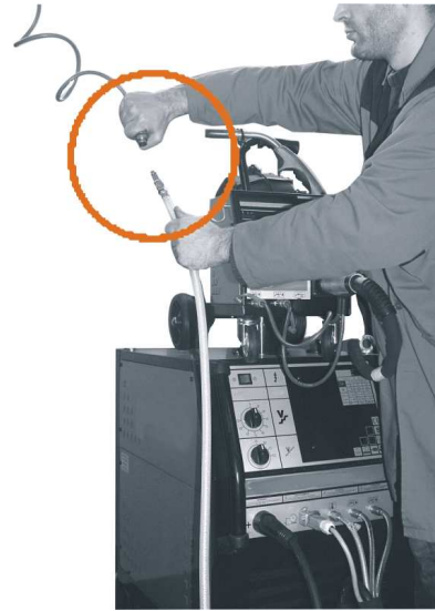
5 – Conectar el tubo de aire comprimido a la red presión min.5 bar, min. flujo 100 lts/min.
