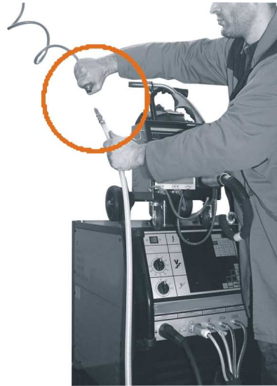
5 – Connecter le tube d'air comprimé du porte-électrode au réseau. Pression min.5 bar, min. flux 100 lts/min.
