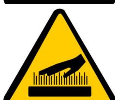
Les pièces chaudes peuvent causer des brûlures. La pièce à travailler, les projections et les gouttes sont chaudes. Utiliser des gants, des tabliers, des chaussures de sécurité et d'autres équipements de sécurité individuelle.
