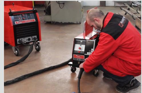
› Possibilidade de converter o retificador numa instalação OPEN-ARC de alto desempenho sem alimentação externa através do AFFLUX 500.
