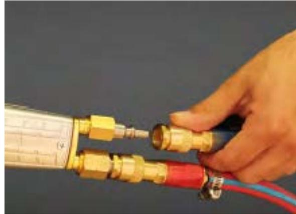
Las válvulas son dispositivos de seguridad que cortan el flujo de gas durante los retrocesos. Las válvulas de acoplamiento rápido permiten sustituir fácilmente los equipos de soldadura y corte y reducen los tiempos de preparación en la producción. Gracias a las conexiones de acoplamiento rápido, se minimizan los riesgos que pueden producirse con los equipos de soldadura y corte. Cuando se retira el conector, el diseño especial de la válvula garantiza el corte automático del gas.
